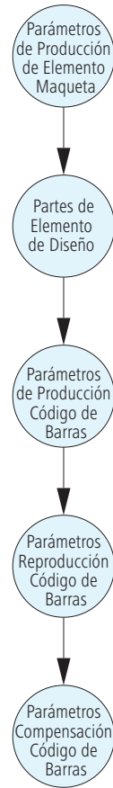
Figura 12.13 “Árbol de recursos” para el proceso Producción de Elemento de Maqueta ( LayoutElementProduction )
