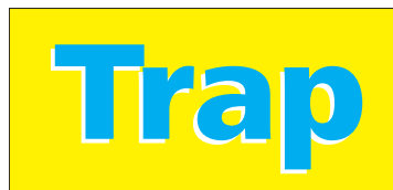
Figura 9.11 Desajuste causado por variaciones de registro sin aplicación de trapping
